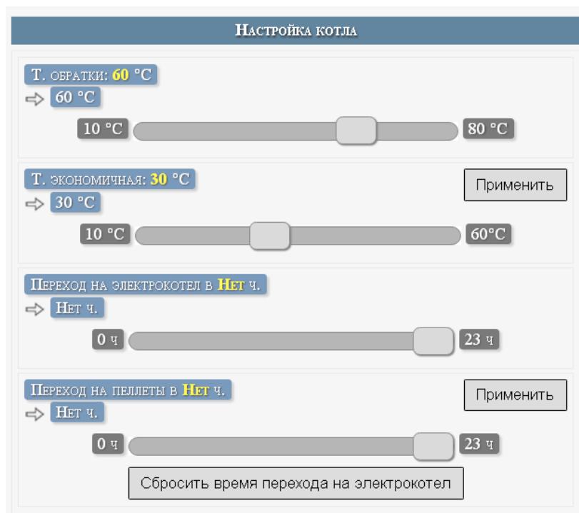
Рис.10.5. Вкладка настройки котла.
