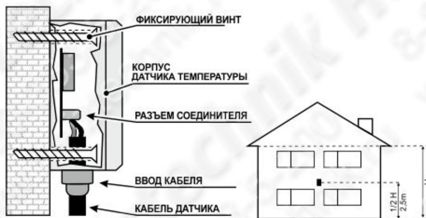
Монтаж уличного датчика
